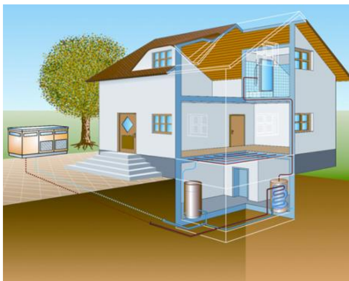
Rysunek 2 Schemat instalacji z powietrzną pompą ciepła 2
