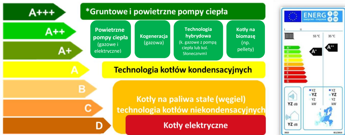
Rysunek 6 Klasy energetyczne urządzeń grzewczych centralnego ogrzewania wodnego (*klasa A+++ będzie wprowadzona od 26 września 2019 roku)
